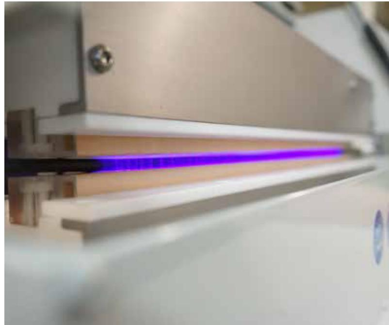
由于类似于PP材料的表面能很低，造成了在印刷后或者胶水粘结后出现油墨脱落和粘结效果不理想的问题。为了获得最佳的粘结效果，提升材料表面能变成至关重要的环节。通过Tantec的电晕设备处理可以显著提高其材料表面能，改善粘合特性。
