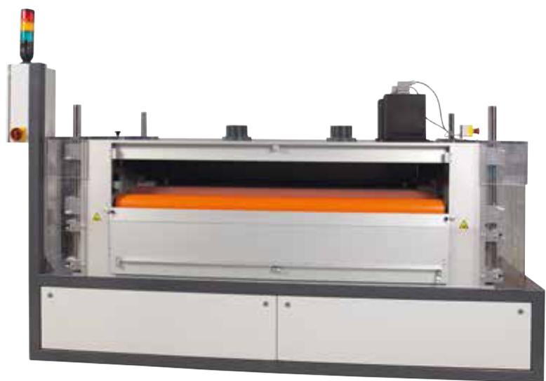
由于类似于PP等高分子材料的板材表面能低，所以其表面不能很好地粘着液体胶和油墨，通过Tantec的电晕系统处理后可以显著提高其表面能量，改善粘合特性。
