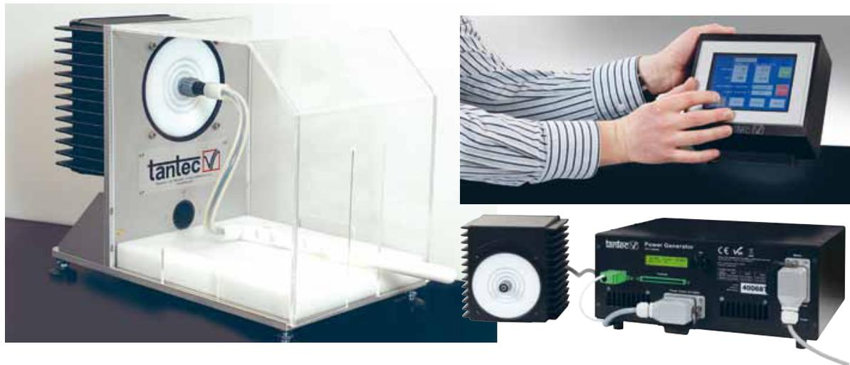
LabTEC是实验室专用的电晕设备。由于该设备为测试装置，所以配套的放电发生器须进行严格控制。手动操作时须注意安全。电极的手柄具有良好的绝缘性，因此操作人员可以手握手柄来处理各种部件。
