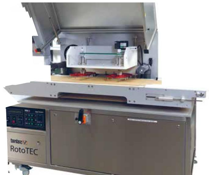
Tantec的RotoTEC-X可在线均匀处理各种注塑部件（在涂层、印刷、粘合、涂漆前），优化特定材料的表面粘合特性，用户可控制所有的参数。
