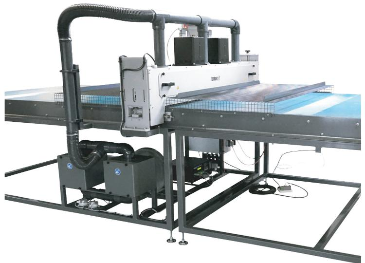
由于类似于PP材料的高分子类材料表面能很低,造成了在印刷后或者胶水粘结后出现油墨脱落和粘结效果不理想的问题。为了获得最佳的粘结效果,提升材料表面能变成至关重要的环节。通过Tantec的电晕设备处理可以显著提高其材料表面能,改善粘合特性。
