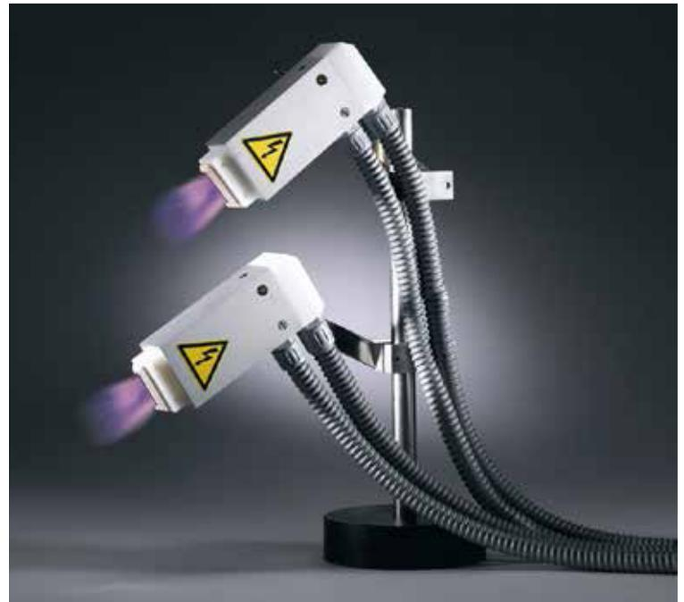
Tantec的SpotTEC设备用于处理橡胶密封性、线缆和注塑部件等表面，并可以集成在生产线上，用户使用起来具有较强的灵活性。基本原理是高压放电的离子在大气压下作用到物体表面，从而提高物体表面附着力。
