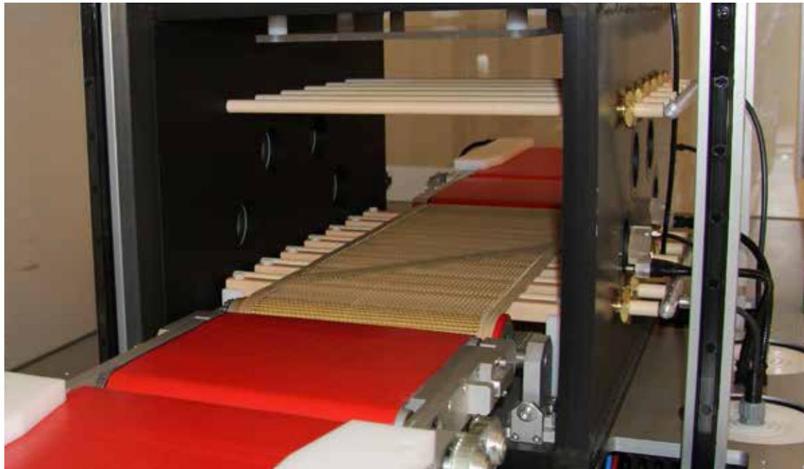
VacuLINE在线式真空等离子设备是针对不同的注射模具产品都可以适用的在线式处理设备。该设备实现了整个处理过程不需要人员操作，并且该设备的快速处理工艺为下游工艺的涂层、胶水、印刷、喷涂提供了最佳的产品表面能与很好的结合性。
