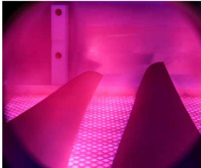
Tantec的VacuTEC等离子处理设备可配置一个或多个托盘，用于处理各种不同材料的零部件表面。该设备处理速度快，可使涂料、涂胶、喷漆及印刷等的粘附特性达到最佳的效果。
